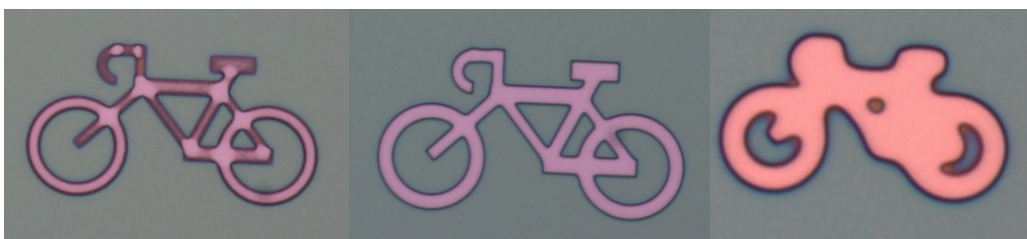
Abbildung 20: links, unterbelichtet, der Lack ist nicht vollständig entwickelt. Mitte die Dosis ist gut gewählt, alle Strukturen sind klar und definiert zu erkennen. Rechts, überbelichtet, die einzelnen Elemente laufen stark ineinander.
